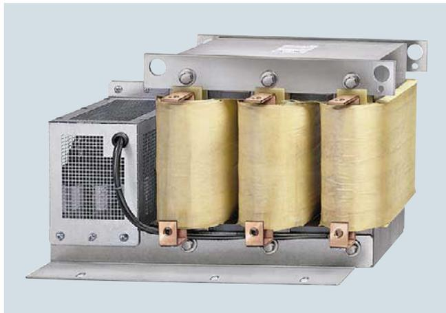
Si se conecta un filtro senoidal a la salida del Power Module o Motor Module, la tensión entre los bornes de motor tiene forma de onda prácticamente senoidal. Esto reduce los esfuerzos dieléctricos en los devanados del motor y se evitan los ruidos del mismo generados por la frecuencia de pulsación.
