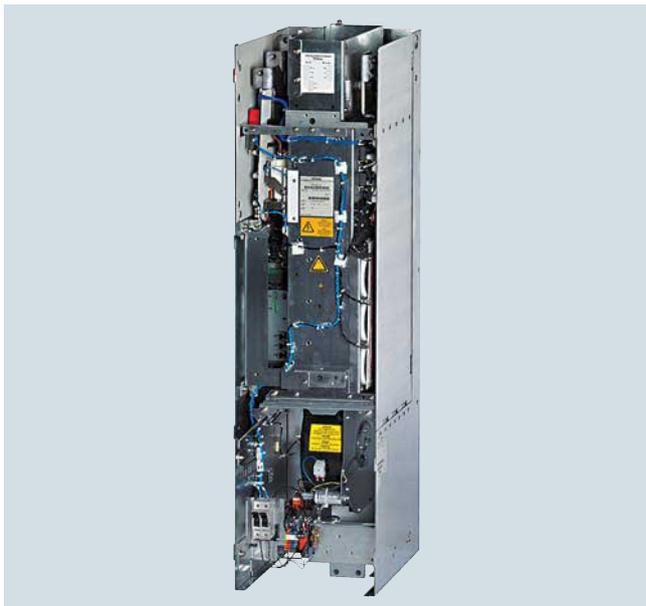
Los Basic Line Modules se usan para aplicaciones donde no hay realimentación de energía pero sí intercambio de energía entre ejes motrices y generatrices a través del circuito intermedio. Los Basic Line Modules son adecuados para conexión a redes con neutro a tierra (TN/TT) y sin neutro a tierra (IT).
