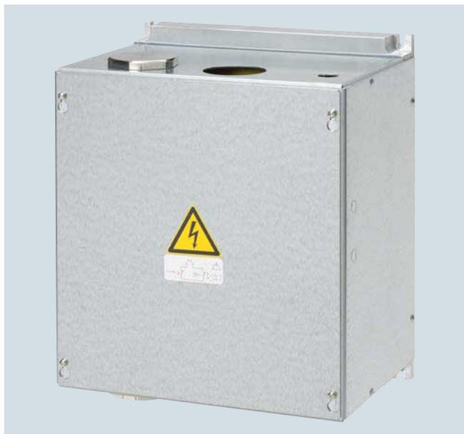
La función VP (Voltage Protection) en los motores 1FE y en los electrohusillos 2SP1 con motor síncrono y fuerza electromotriz  $\dot{U} > 820 \text{ V}$  a 2000V ( $U_{ef}$  570 V a 1400 V) se aplica para limitar la tensión del circuito intermedio del accionamiento en caso de fallo.
