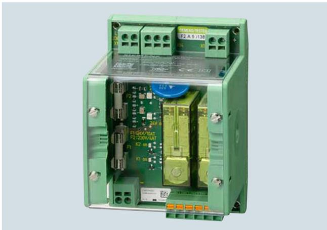
Un Safe Brake Adapter SBA es necesario para controlar con seguridad el freno de mantenimiento del motor de los equipos SINAMICS S120, S150, G130 y G150 mediante la función Safe Brake Control (SBC), de acuerdo con IEC 61800-5-2.
