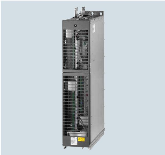
Las unidades de alimentación/realimentación autoconmutadas (con IGBT en el sentido de alimentación y realimentación) generan una tensión regulada en el circuito intermedio. De este modo, los Motor Modules conectados están separados de la tensión de la red. Las fluctuaciones que se producen dentro de los valores tolerados para la red no influyen en la tensión del motor.
