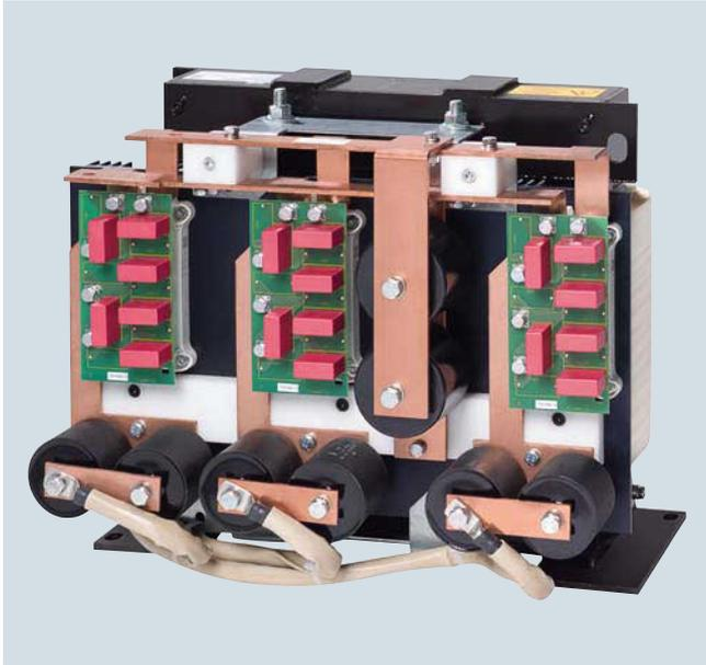
Los filtros du/dt tipo compact plus VPL (**V**oltage **P**eak **L**imiter) limitan la velocidad de subida de tensión  $du/dt$  a valores  $< 1600 \text{ V}/\mu\text{s}$  y los picos típicos de tensión, a los siguientes valores de acuerdo con la curva límite A especificada en IEC 60034-25: 2007:
