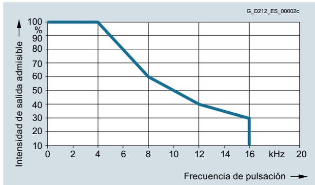
Intensidad de salida en función de la frecuencia de pulsación (Single Motor Modules, forma Booksize, intensidad asignada hasta 132 A)
