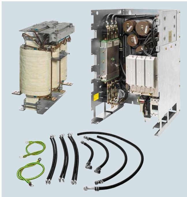
El Active Interface Module consiste esencialmente de una bobina de filtro refrigerada por líquido y un módulo de filtro refrigerado por líquido. El módulo de filtro incluye un Clean Power Filter con supresión básica, la conexión de precarga para el Active Line Module, el detector de tensión de red y los sensores de control.
