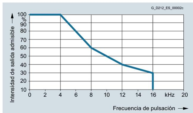
Intensidad de salida en función de la frecuencia de pulsación
