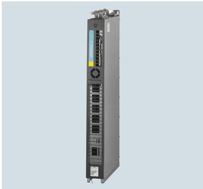
Los Basic Line Modules se usan para aplicaciones en las que no hay energía de realimentación o en las que el intercambio de energía entre los ejes motores y generadores se produce en el circuito intermedio. La precarga de los Motor Modules conectados tiene lugar a través del circuito de puerta de los tiristores. Los Basic Line Modules son adecuados para conexión a redes con neutro a tierra (TN/TT) y sin neutro a tierra (IT).
