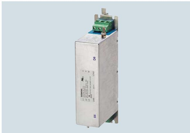
Asociados a bobinas de red y una instalación conforme del conjunto, los filtros de red limitan las perturbaciones conducidas que emiten los módulos de potencia a los valores especificados para la clase A1 según EN 55011 y categoría C2 según EN 61800-3. Los filtros de red sólo son aptos para la conexión directa a redes TN.
