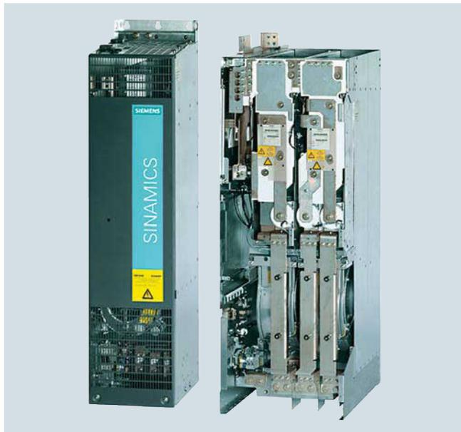
Las unidades de alimentación/realimentación autoconmutadas con IGBT generan una tensión regulada en el circuito intermedio. De este modo, los Motor Modules conectados están separados de la tensión de la red. Las fluctuaciones que se producen dentro de los valores tolerados para la red no influyen en la tensión del motor.
