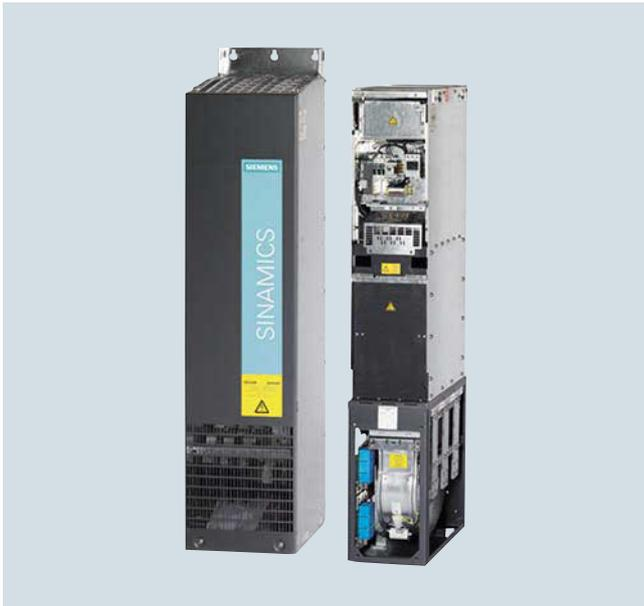
Los Active Interface Modules se utilizan asociados a los Active Line Modules. Los Active Interface Modules contienen un Clean Power Filter con supresión básica, el circuito de precarga para el Active Line Module, la unidad sensora de la tensión de red y sensores de vigilancia. En los tamaños FI y GI ya está incluido el contactor de puenteo o bypass. Por eso, el diseño es muy compacto. En los tamaños HI y JI, el contactor de puenteo se debe prever por separado.
