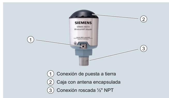
Adaptador Wireless HART SITRANS AW210, estructura
