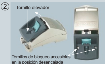
Soltar el inserto con el tornillo elevador y tirar de él hasta desenchajarlo
