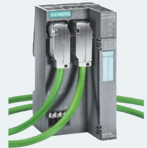
Módulo de interfaz IM 151-3 PN HF para PROFINET con cable estándar
