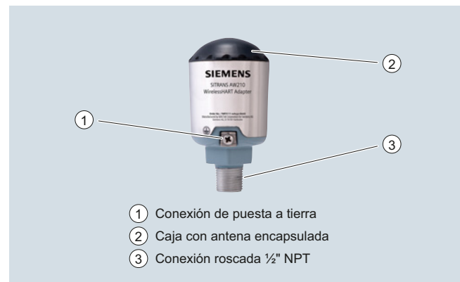
Adaptador Wireless HART SITRANS AW210, estructura
